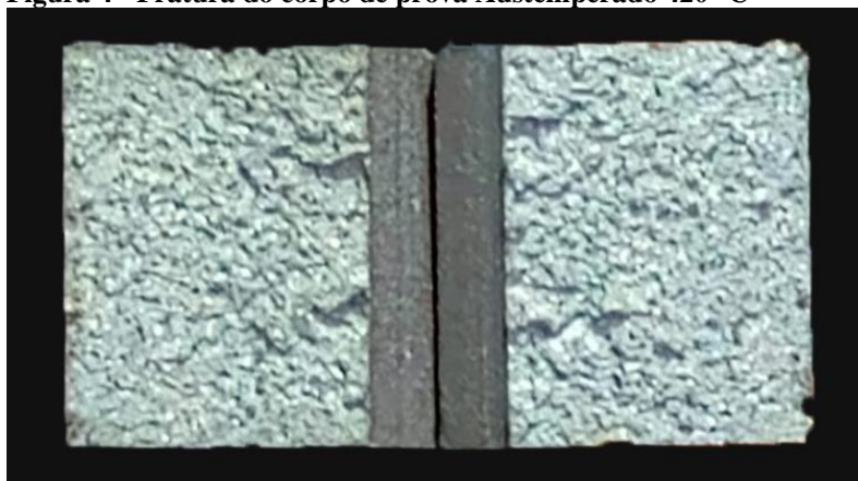
Figura 4 - Fratura do corpo de prova Austemperado 420 °C
